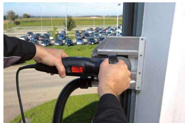
Le carter d’aspiration spécialement bas, fermé et robuste permet d’incliner la machine pour découper directement au-dessus du cadre de la fenêtre.
